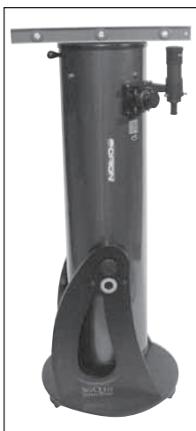
Figure 8. Placez un niveau à bulle sur la base comme indiqué. La base doit rester de niveau lors d'une rotation de 180° en azimut. Une fois que la butée verticale est réglée, la base n'a pas besoin d'être de niveau pour fonctionner correctement.
