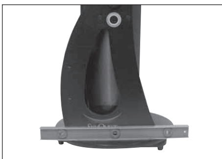
Figure 8. Placez un niveau à bulle sur la base comme indiqué. La base doit rester de niveau lors d'une rotation de 180° en azimut. Une fois que la butée verticale est réglée, la base n'a pas besoin d'être de niveau pour fonctionner correctement.
